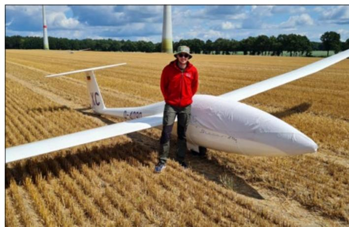
15 Meter Spannweite hat das Segelflugzeug des Modells Discus 2b, das eine Höchstgeschwindigkeit bis 250 Stundenkilometer erreicht und über eine Startmasse von 525 Kilogramm verfügt.
